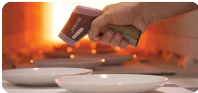
Avaliação da temperatura do material cozido à saída do forno híbrido de rolos do CTCV.
