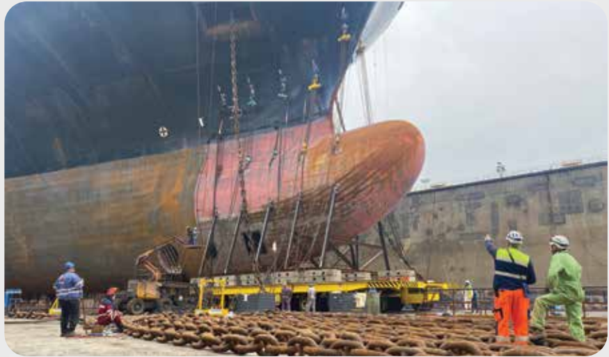
Fig. 1- Substituição de Bolbo em doca seca no Estaleiro da Mitrena
